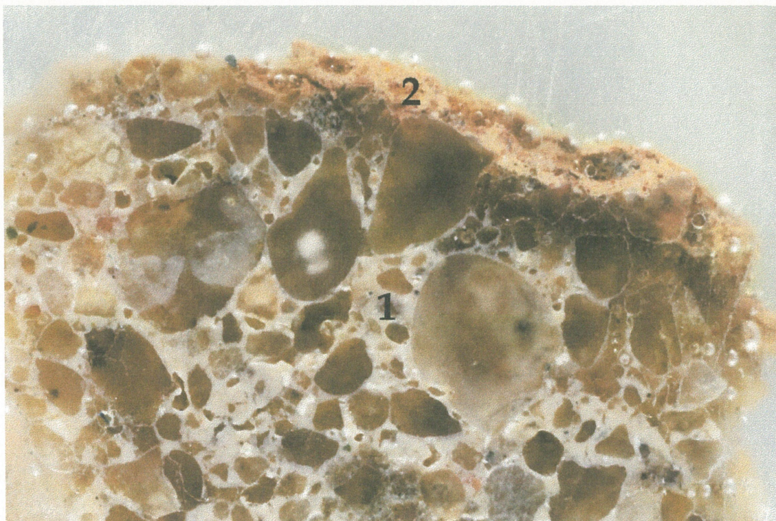
Fot. 13. Odkrywka nr 1 – zdjęcie szlifu przekroju stratygraficznego (próbka pobrana ze ściany południowo-zachodniej).
